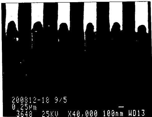
그림 16. Carl 테크닉을 사용하여 가시광을 이용 제작된 0.25um 패턴
