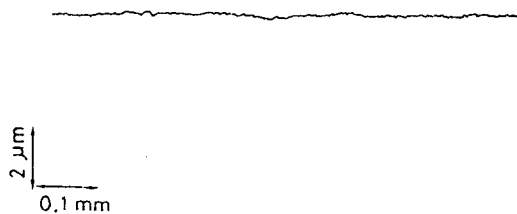
그림 9 동합금 Lead의 표면조도 Fig. 9 Behavior of surface roughness on Cu alloy lead.
