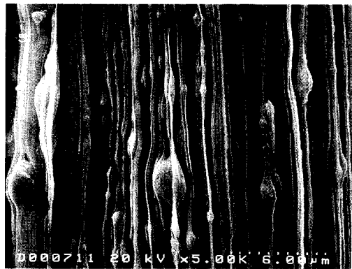
그림 11. 다심 선재중의 Nb-Ti filament의 미세조직 사진 Fig. 11 Photograph of microstructure of Nb-Ti filament in multi filament wire
