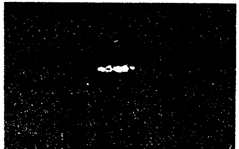
그림 10. 단일 광 변조기의 다중모드 출력 상태 Fig. 10. Multi mode output of single optical modulator.
