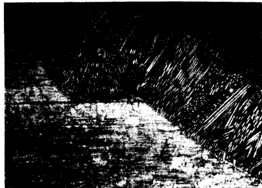
사진 3 Lap 이음부에서의 불균일 용입 현상
