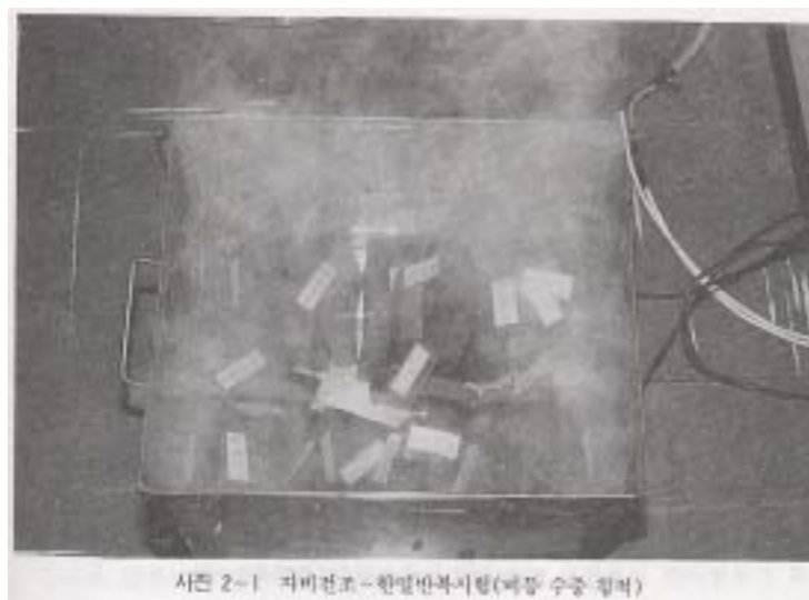
사진 2-1 자비건조-한열반복시험(비등 수증 침적)
