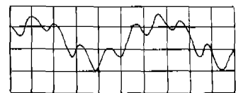
<그림 9> 콘덴서를 통과하는 전류파형 (사이리스터 장치 운전중)
