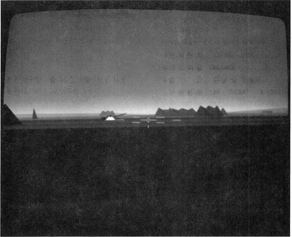
CGI 포술훈련 모의장비는 교실용으로서 훈련자용 Cabin에 전차의 Gunner Station을 설치하고, Gunner의 Sight를 통해 모니터를 보게되며, 모니터에는 사전에 Program된 컴퓨터 영상이 출력되어 다양한 전장 시나리오를 보면서 사격훈련을 하게 된다
