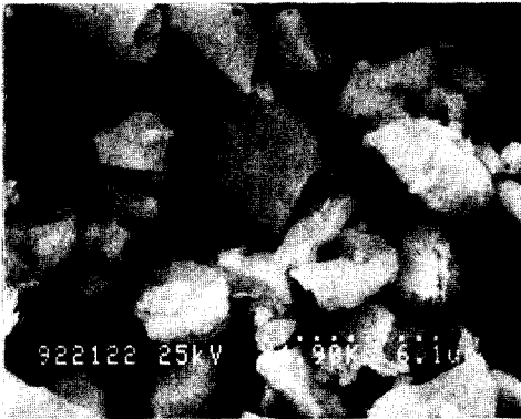
그림 2. glass frits의 SEM 사진 Fig. 2. SEM micrograph showing glass powder.
