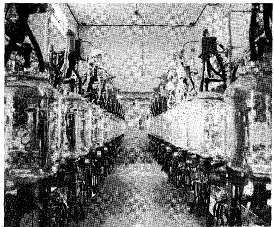
〈사진 17〉 단일규모로서는 국내 최대인 2×12.24두용 헤링본형 착유실 내부(설치 당시 첨단 편의장치를 고루 갖추었다)
