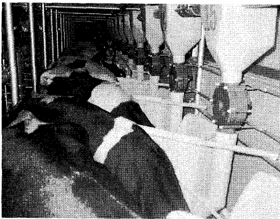
〈사진 18〉 착유실 농후사료 공급용 오거컨베이어(우군의 능력에 따라 일률적인 정량을 설정하여 공급할 수 있다)
