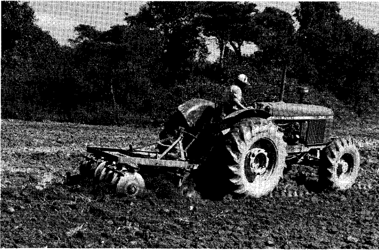
◁림 3 쇠토작업 (디스크 해로우) 쇠토는 토양의 성질에 따라 디스크 해로우를 2~4회 끌어 준다.
