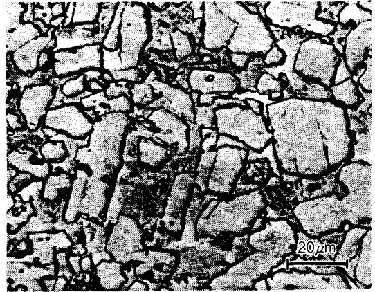
〈사진-2〉 試製크링카의 顯微鏡寫眞
