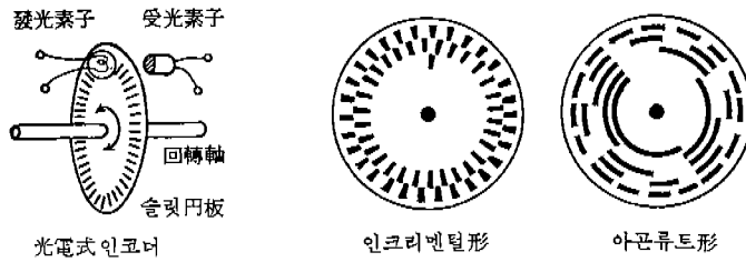
〈그림 4·6〉 인코더의 構造
