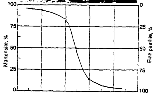
그림 13. 담금질된 강에서 경화부와 소재부의 Martensite에서 Pearlite로의 천이지역 (遷移地域)
