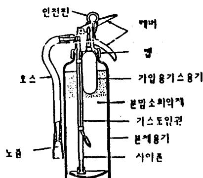
보통 本體容器內部의 加壓은 常壓(大氣壓)이며 使用時に 加壓用가스 容器를 開封하는 瞬間 二酸化炭素가스 혹은 窒素가스에 의하여 急速히 加壓된다. 이때 本體内部에 걸리는 壓力은 加壓
