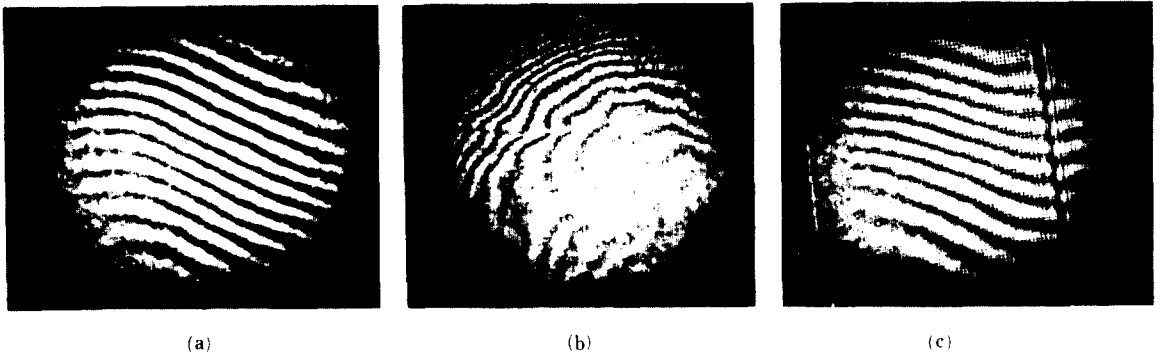
그림 4. Mach-Zender 간섭계로 측정한 실험 결과 (a) LCTV를 삽입하지 않은 경우 (b) 상용 LCTV를 삽입한 경우 (c) 수정된 LCTV를 삽입한 경우
