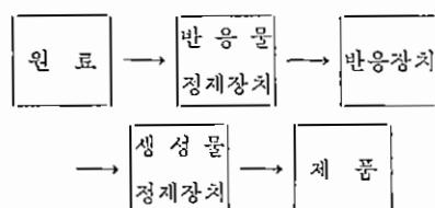
화학공학 기사는 위 흐름도의 각 공정 및 전체 공정의 기술 내용과 장치에 대한 지식을 가지고 있어, 최적 운전 조건을 알고 있고, 새로운 장치의 개발이나 설계 및 운전 조작을 가능
