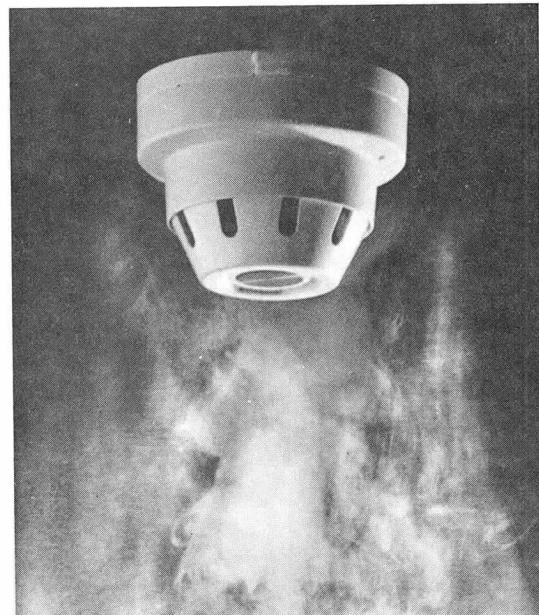
을 감지기별로 분석하여보면 차동식 스포트형의 경우 다이아후램의 특성변화, 분진 등으로 인한 리이크공의 막힘, 접점 간격의 이완 등에 영향이 있으며 정온식 스포트형의 경우에는 바이메탈의 열팽창계수의 불균형 및 피로 현상에 기인되는 것으로 판단된다. 이온화식 연기감지기의 경우에는 분진 등의 누적으로 인한 감도 저하와 반도체 저항 등 부품소자의 성능 변화에 따른 결과로 판단된다.
