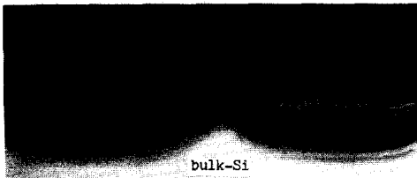
그림17. PSL 형성 반응이 끝난 n형 실리콘 island의 단면사진 Fig. 17. Optical micrograph of the n-Si island. (cleaved cross-section, 360X, W=100 μm).
