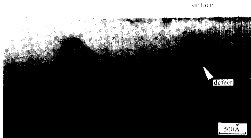
그림 8. (b) 250 Å SiO 2 를 통해 Si 속으로 BF 2 + , 50KeV, 5 × 10 15 /cm 2 를 이온주입 한 후 950°C, N 2 에서 40분 열처리 한 시편에 대한 TEM 관찰(×300,000)
