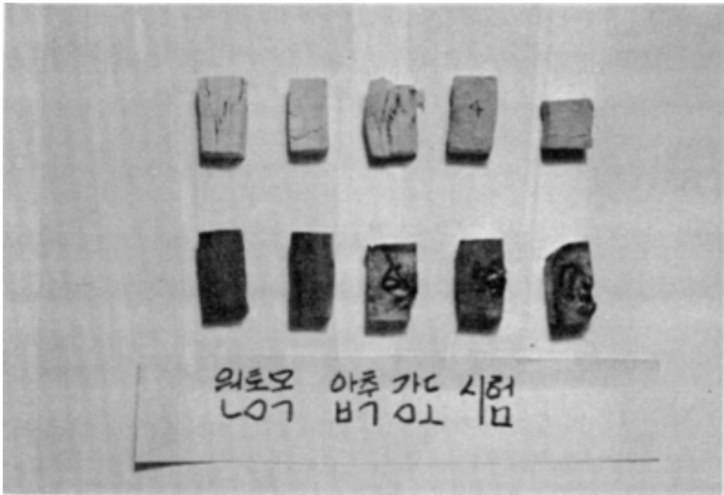
사진 4-2) 壓縮強度試驗 후 試片의 變形
