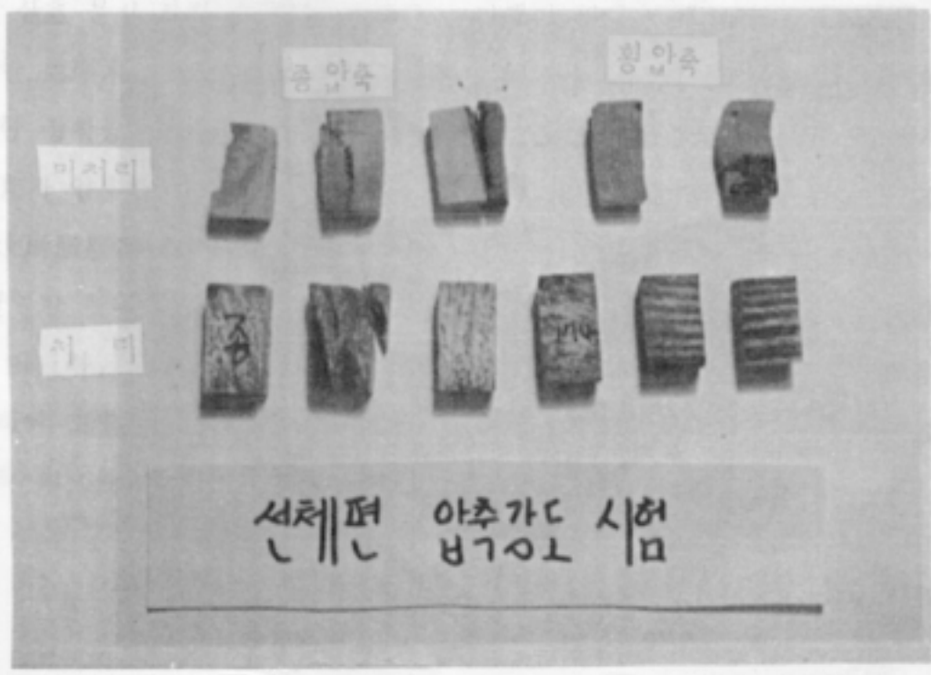
사진 4-1) 壓縮強度試驗 후 試片의 變形
