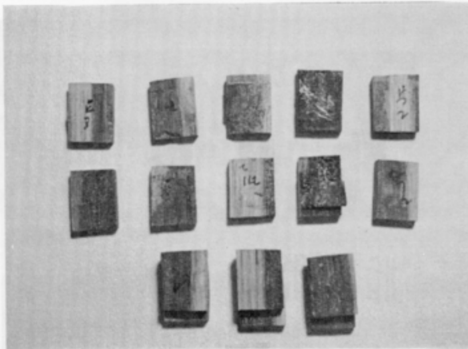
사진 7) 接着强度測定 후 試片 上左: 멜라민-요소, 페놀, 레졸시노올, 시아노 아크릴 레이트, 부틸, 제 고무접착제 下左: 네오프렌, NBR, SBR
