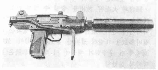
Mini-Uzi 에 부착된 銃口消音器. 이로써 火器의 길이 및 重量이 증가하였으며, 火器의 操作性이 향상되었다. 다른 機關短銃보다 월등히 우수한 IMI 사의 Uzi 계열 火器에 Wilson Arms Company 社製 消音器가 장착되고 있다.
