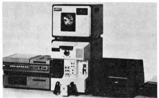
射手의 位置를 再生할 수 있는 비디오 디스크型 戰車射手 訓練器, 모니터 및 教官用 制御터미널
