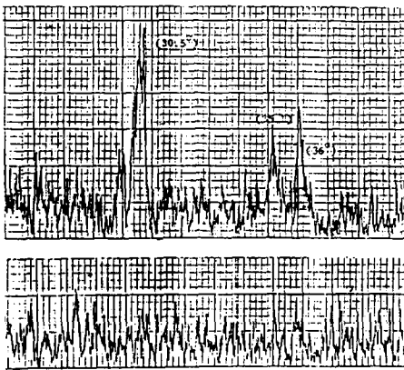
그림 16. X-선 회절분석 (a) Sb 2 S 3 분말 (b) Sb 2 S 3 막막 Fig. 16. X-ray diffraction patterns. (a) Sb 2 S 3 powder. (b) evaporated Sb 2 S 3 thin films.
