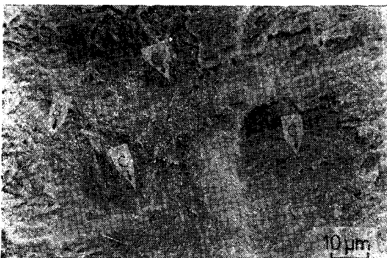
C : Quasi-Cleavage, S : Striation (a) S max : 313MPa N f : 1.5×10 4 cycle
