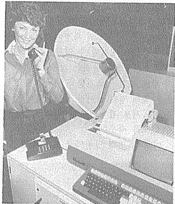
Oceanray로 불리는 이 시스템은 인마르세트(INMARSAT) 해양통신위성과 연결되어 활용될 수 있도록 설계되었으며 선박의 레이다 등에 설치하기 위한 0.9m 직경의 접시형 안테나와, 제어 및 동력공급을 위한 고주파 발생장치의 2개부분으로 구성되어 있다. 접시형 안테나는 선박의 운동에도 안정성을 유지한다.
