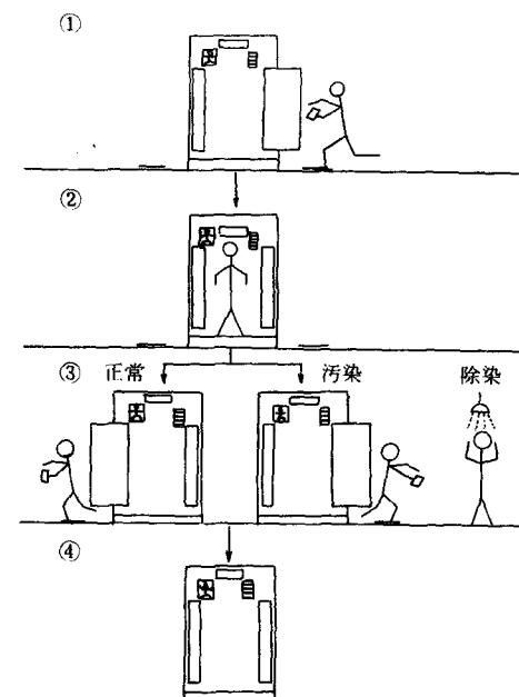
있으며, 좌우 측면의 검출기를 모터로서  $90^\circ$ 회전시키는 자동문장치가 있어 관리구역 출구의 게이트기능을 가진 구조로 되어 있으므로 오염된 사람이 관리구역 밖으로 나갈 수 없다. 頭上檢出器는 개인차가 큰 신장의 고르지 못함에 대응하여 자동으로 상하로 이동하여 머리에 접근할 수 있는 구조로 되어 있으며, 制御, 計測回路를 포함하여 面積  $1.2\text{m}^2$ 정도로 콤팩트하다. 무엇보다도 hand foot cloth모니터가 설치되어 있는 베이스에 그대로 교환설치를 할 수 있는 장점을 갖고 있다. 오염검사의 동작을 그림1에 나타내었다.
