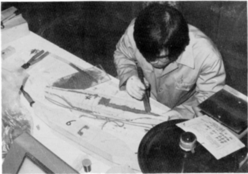
사진 3. 破損된 試片을 人工木材合成樹脂로 再接着시켜줌.
