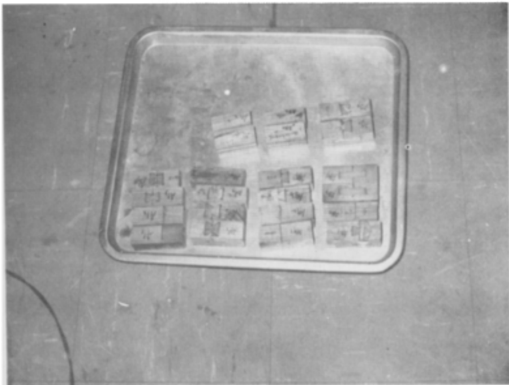
사진 8. 壓縮強度試驗을 위하여 木材로 製作한 시험試片
