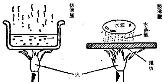
燃料棒에서 冷却水에의 熱傳達은 불에相當하는 燃料棒의 發熱量, 남비에 상당하는 燃料被覆의 性質, 冷却水의 流量에 의해 영향된다. 만약 충분한 熱除去가 되지 않으면 燃料棒은 局部의로 膜沸騰을 일으켜 溶融하는 버언나우트라고 불리우는 파괴를 일으킬지도 모른다. 原子爐내는 核分裂이 반드시 같은 상태로 일어나는 것은 아니나 最高의 發熱을 하고 있는 燃料棒에 대해서도 버언나우트 되지 않도록 하는 것은 물론 충분한 여유를 갖고 熱傳達이 이루어지도록 設計된다.
