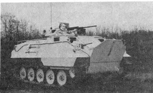
7.62mm 기관총을 裝着하고 水上運行을 위해 胴體 前面의 트림베인을 세우고 있는 ACEC社 코브라의 네 번째 試製車輛
