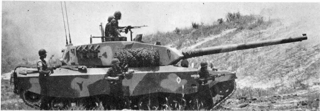
6개의 보기륜을 갖는 Osório의 車體는 프랑스 AMX40과 유사하며, 砲塔에 대해서는 그 실루엣이 英國의 Valiant를 연상케 한다. Osório는 이러한 두 유럽戰車의 직접적인 경쟁차량이 될 것이다.
