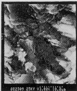
그림 6 方解石의 주사전자현미경사진( \times 3,000 ).
