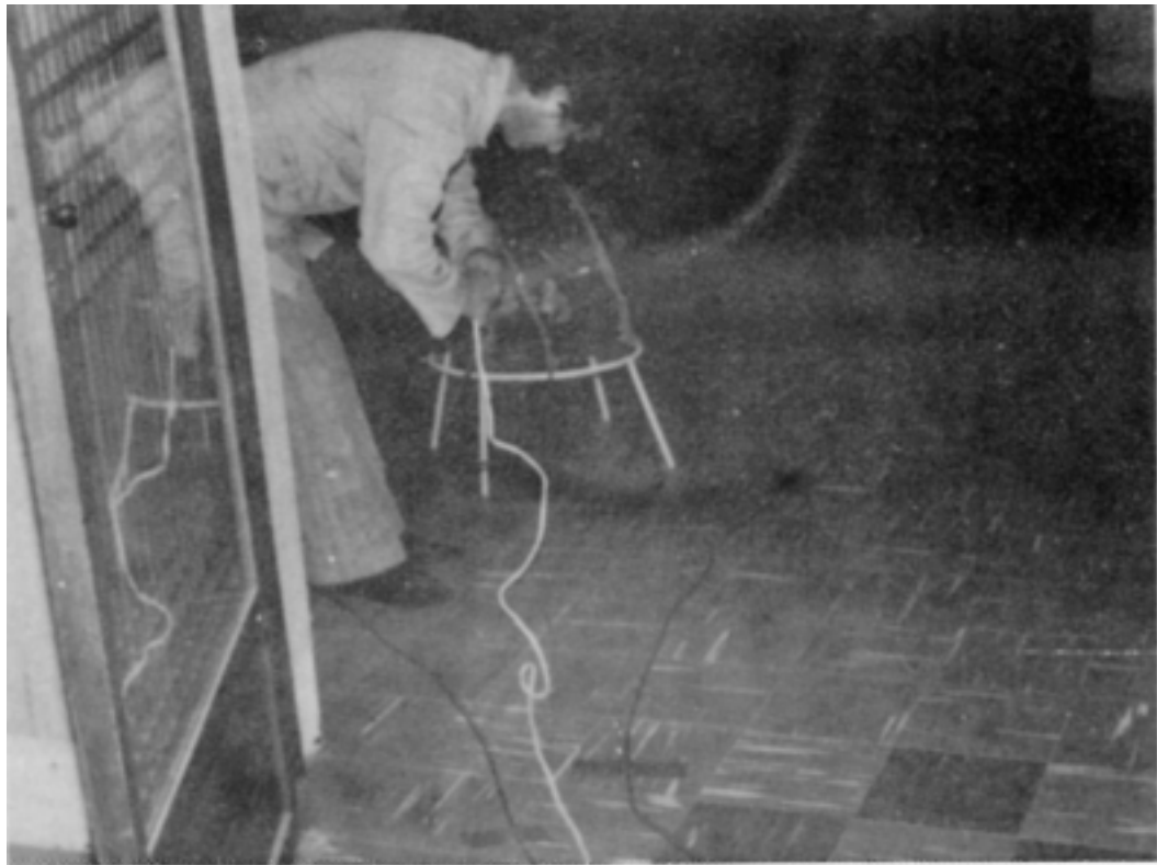
<사진 5> Gas 濃度 均一化를 위하여 Fan 設置
