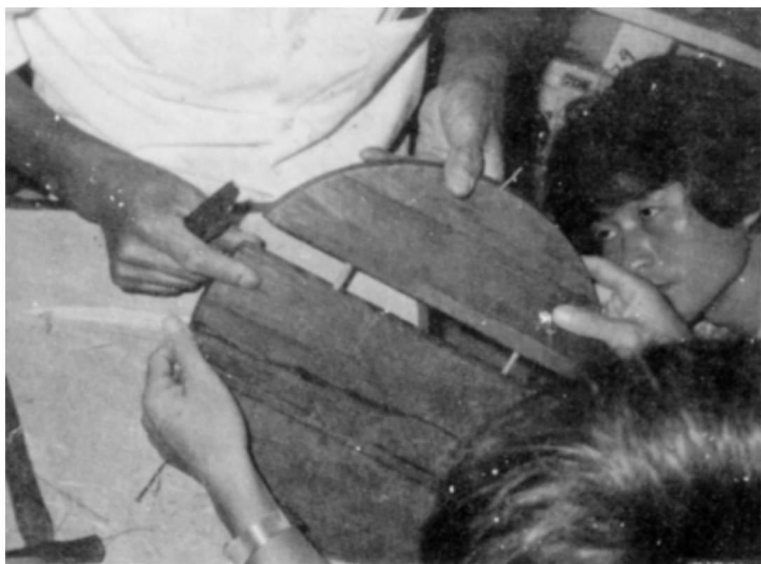
(圖版 4-4) 연결 못을 이용하여 양면을 接合하는 過程
