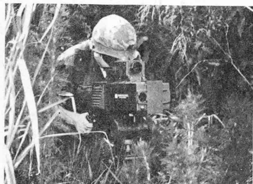
LORADS 레이저 標의 指示器는 各種의 地對地, 空對地 레이저誘導武器에게 目標을 照明 指示해 준다.
