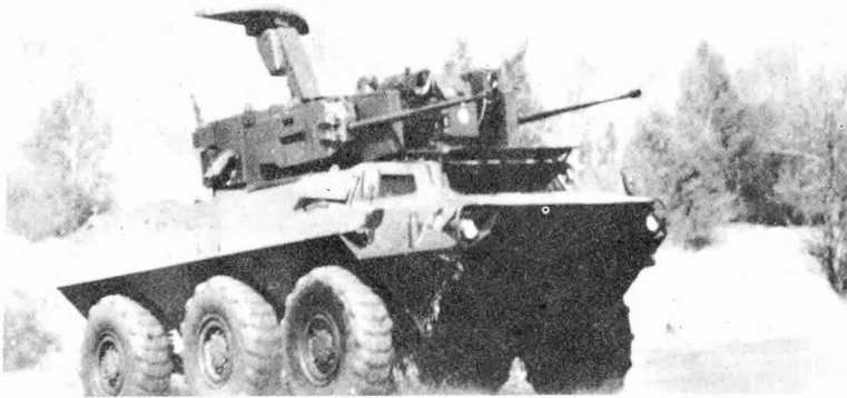
〈그림 2〉 차체 레이더와 口徑 30mm 쌍열砲가 장치된 自走對空砲 WILDCAT
