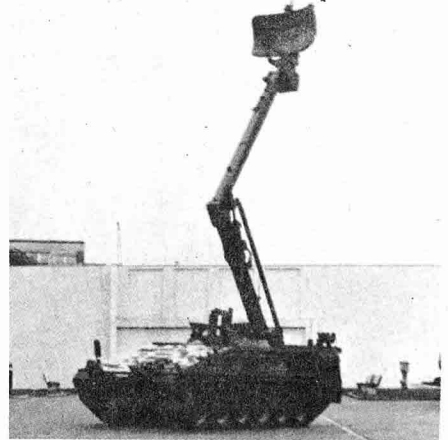
〈그림 9〉 西獨 육군이 보유하고 있는 搜索레이다 (E 밴드) : 位置가변식가대에 장치되어 30 km의 領域을 담당한다.
