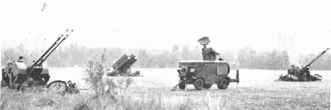
〈그림 1〉 誘導미사일과 對空砲의 혼합운동 체계인 SKYGUARD 對空武器 체계
