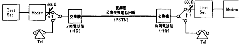
그림16. 傳送速度 1200bps 및 2400 bps에 對한 公衆交換電話回線 試驗系統圖
