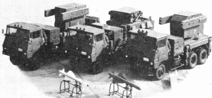
短距離用 SAM시스템 ; 中央은 誘導레이더, 兩쪽에 있는 것은 發射台車輛, 바로앞에 있는 것은 彈體이다.
