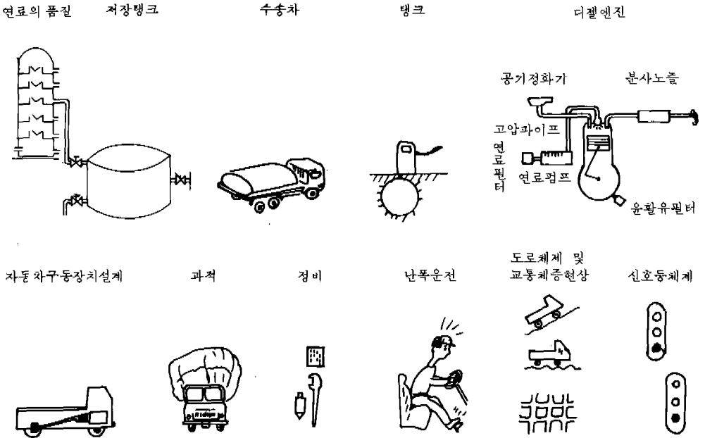
그림2. 輕油自動車의 煤煙發生要因
