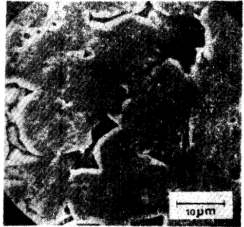
그림 18. 1,340°C에서 열처리된 시편의 표면(×1800) Fig. 18. The surface of e-2 specimen fired at 1,340°C for 2hr (×1800)
