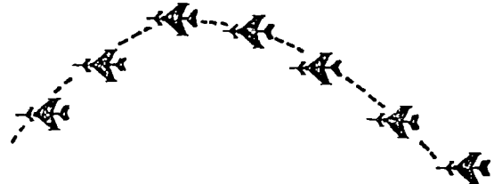
機首方向을 바꾸지 않고 左右로 移動(直接橫力制御)
