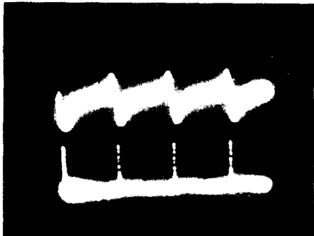
사진 1. 증폭된 sensor 신호 및 코일 1차측 전압 (10 ms/div.)
