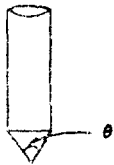
그림 2. 針電極의 尖銳度 角 \theta Fig. 2. Angle \theta , the sharpness of needle electrode
