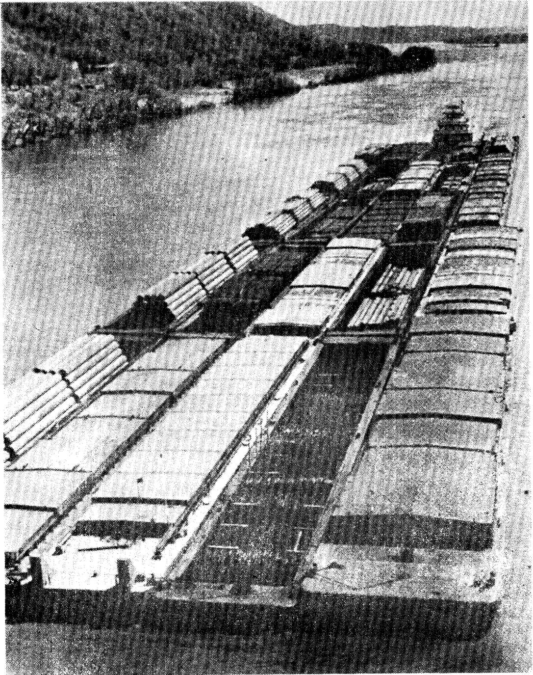
그림 1. Barge 船團의 장관 (towboat : 3240 hp, barge : 25 隻)
