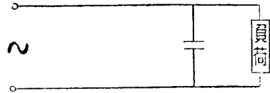
圖 1. 個別負荷에 對한 Condenser 接續圖
