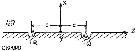
接地電極(Ground Electrodes)間的 地中抵抗(Earth Resistance)을 測定하기 爲하여 上圖와 같이  $2c$ 單位 거리에 各各半徑이  $a_1, a_2$ 의 半球를 땅에 묻고 電極으로 使用하기로하자.
