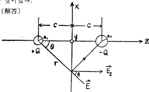
(ㄱ) 地中에서의 電流分布狀態는 Electrostatic Field Lines와 同一함으로
