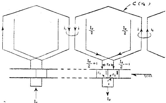
(Armature coil)에 流하는 電氣에 對한 微分方程式은 아래의 假定에 依하여 다음과 같이 얻을 수 있다. (그림 參照)
