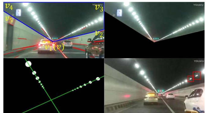
그림 1. 영상정보를 통한 터널 내 조명 검출 과정
