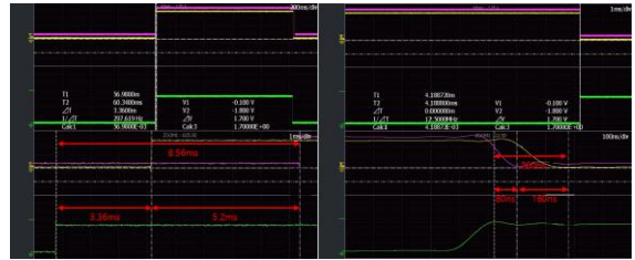
(그림 5) AGT / PTP Timer 오실로스코프 측정 과정
