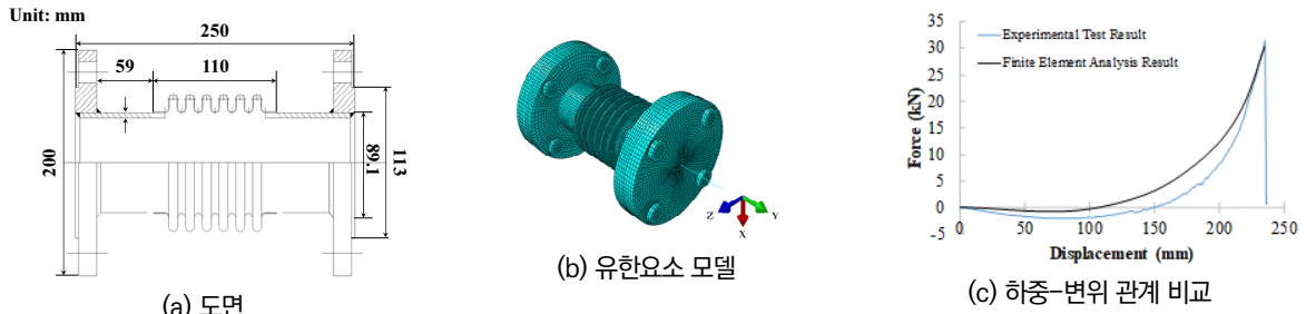
그림 1. 벨로우즈 신축이음관의 고충실도 유한요소 모델 구축 및 검증 (손호영 등, 2022)
